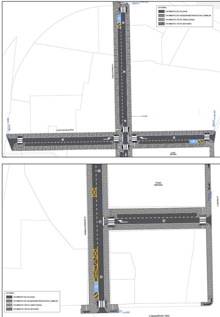
Ilustración 9. Planta de pavimentación en las calles de estudio. Fuente: Proyecto de construcción de mejoras de urbanización para la movilidad peatonal sostenible en la C/ Sagrada Familia, Don Juan de Austria, Plaza Senyera y Felipe II.
