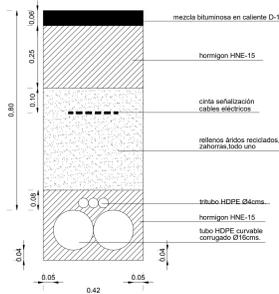
CANALIZACIÓN C5 ENTUBADA EN CALZADA CON 4 TUBOS DE Ø160
