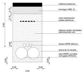
CANALIZACIÓN C6 ENTUBADA EN ACERA/TIERRA CON 4 TUBOS DE Ø160
