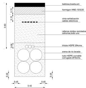
CANALIZACIÓN C3 ENTUBADA EN ACERA/TIERRA CON 6 TUBOS DE Ø160
