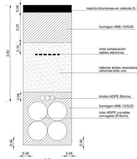
CANALIZACIÓN C4 ENTUBADA EN CALZADA CON 6 TUBOS DE Ø160
